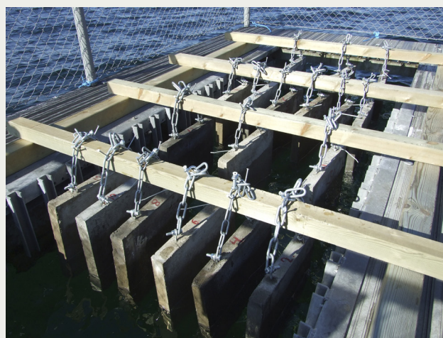
Figur 1. Exponering av betongblock med hög kloridhalt (3 % klorider per bindemedelsvikt) vid Swerea KIMAB:s forskningsflotte vid Bohus Malmön.
