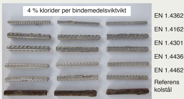
Figur 4. Utseendet hos provstänger av rostfritt stål och kolstål efter två års exponering utomhus. Inga korrosionsskador kunde konstateras på rostfria stänger.
